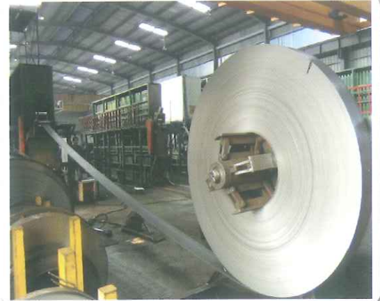
Sau đó được chuyển vào dây chuyền máy cán ống hoặc xà gồ (Then, they are moved into the pipe rolling machines line or purlin)
