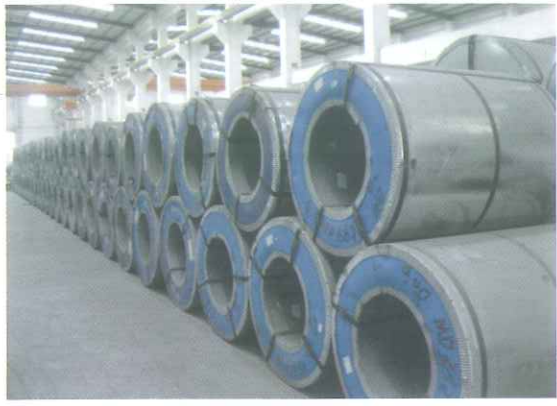
Nguyên liệu dạng cuộn được chọn lọc, kiểm tra kỹ càng trước khi chuyển vào bộ phận xẻ băng (Rolled coil materials are selected and tested particularly before being moved into slitting period)
