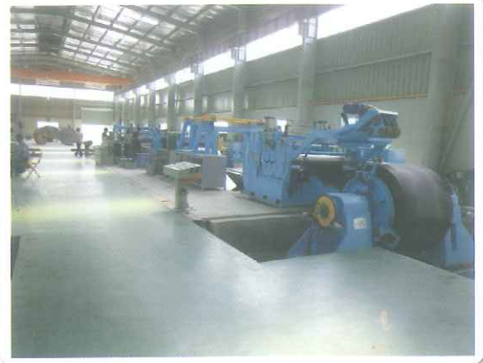
Máy xẻ băng xẻ bản rộng tùy theo từng size ống (The slitting machine has various wide plates depending on pipes size)
